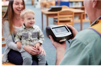
スポットビジョンスクリーナーでは患者の両眼の屈折力、瞳孔の大きさ、および眼位を計測することにより6つの弱視(近視、遠視、乱視、不同視、斜視、瞳孔不同)の危険因子を検出いたします。
