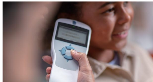
機器先端のプローブで外耳道を密閉し空気圧を変化させながら検査音を発生させ鼓膜から反射された音を測定します。結果はティンパノグラムという波形で表示され、グラフの形から中耳の状態を把握することができます。
